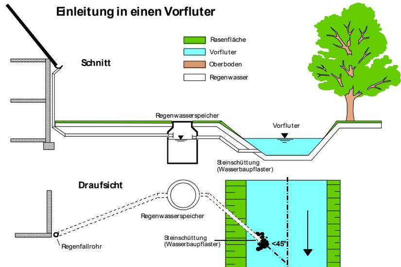
Bei der Einleitung in das Gewässer wird das Einleitungsrohr in Absprache mit dem Unterhaltungsträger verlegt, da hier der Ausbauzustand des Gewässers beachtet werden muss. Dazu zählen zum Beispiel das Uferprofil, vorhandener Uferbewuchs und der mittlere Wasserstand. Werden nicht nur Dach-, sondern auch Hofflächen entwässert, muss zumindest ein Absetzschacht vorgeschaltet werden.
